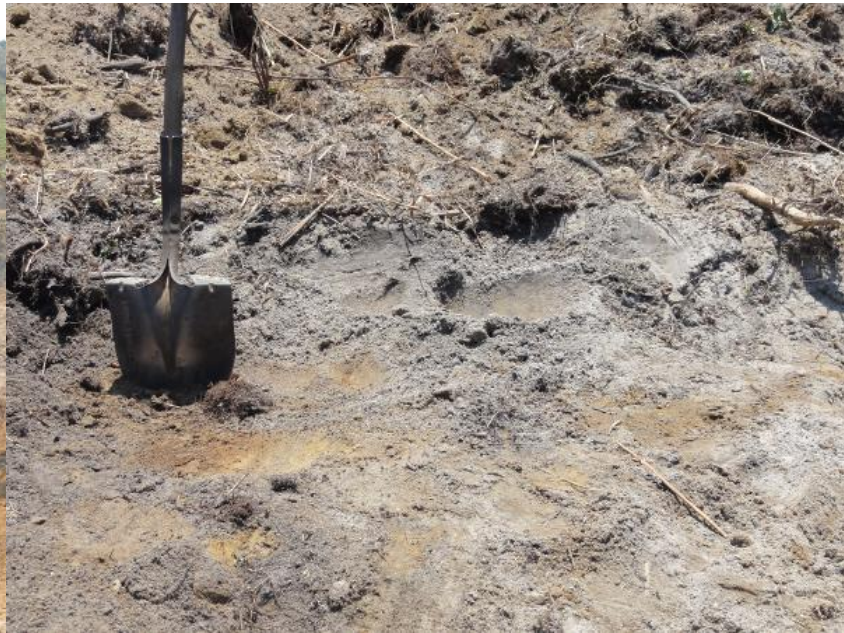
Rechts: Hier trifft der Sandboden auf festeren Boden, wo bei Sättigung des Bodens Wasser rinnen kann.
